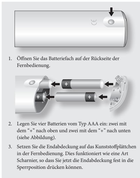
1. Öffnen Sie das Batteriefach auf der Rückseite der Fernbedienung.
